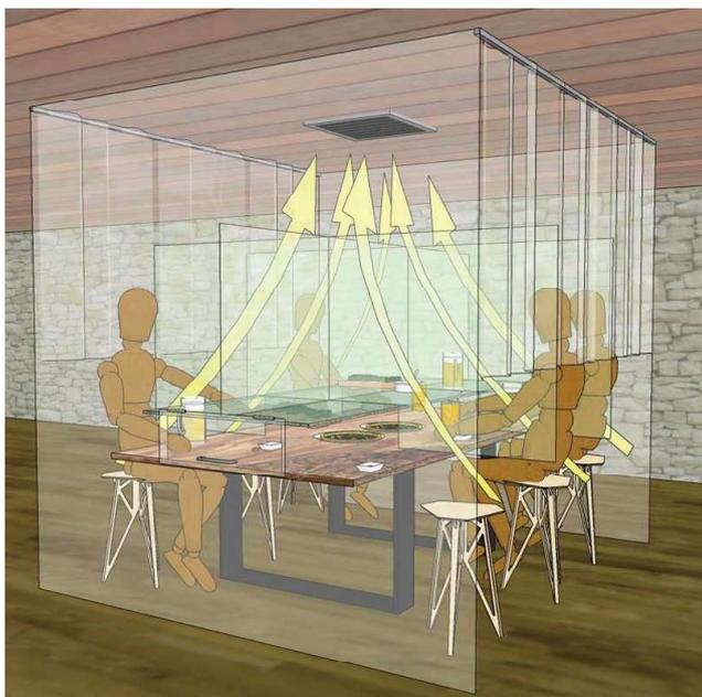
1つのテーブル全体をビニルカーテンで覆い、ドラフトチャンバー状の空間を構成します。席同士もそれぞれスクリーンにより区画し、背後のカーテンや暖簾によって低い位置から外気を誘引する換気を行うことにより、同一テーブルの客同士の感染の防止を図りつつ、客の呼気をテーブル外に漏出させないようにすることができます。
