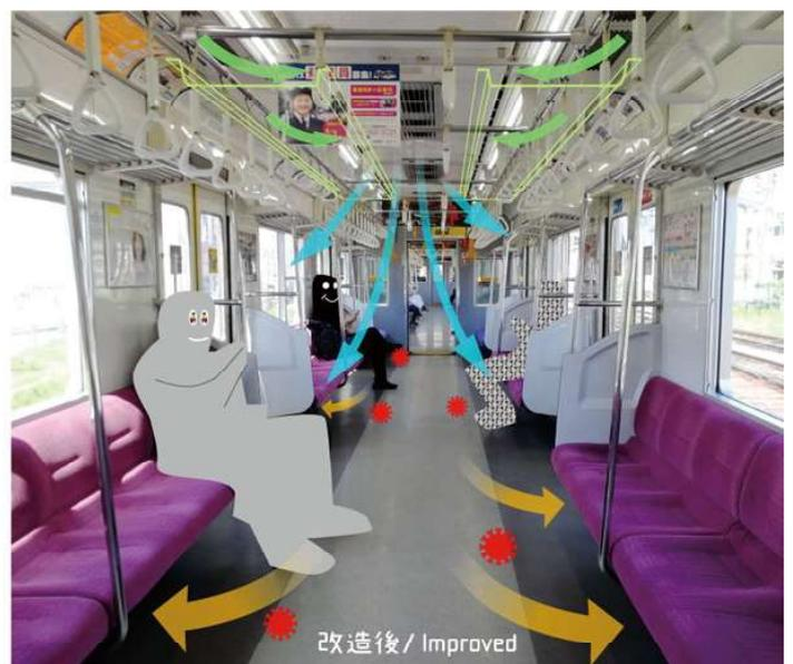
上図では、外気接続口とパッケージエアコンの空気の吸込口とをカバーで被覆して連絡させ（ダクティングし）、外気接続口の排気ファンを電気的な方法または機械的な方法により反転させることで給気ファンとして機能させ、取り込んだ外気を直接加熱または冷却して車内に供給する構成を提案しています。ベンチ下部の壁面に新たに開口を設け排気ファンを設置することにより排気が可能となり、車両は高度な置換空調が可能となります。排気は、ベンチ下部から吸込み、乗降口脇や車両端部にて縦ダクトにより天井付近に誘導して排出する構造とすると、新たな開口の加工が不要となり、また、熱交換器の設置により取込外気と熱交換を行う構成とすることが可能となる為、省エネ効果の向上も期待することができます。
